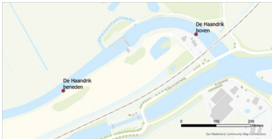
Figuur 6.49 Plaatsing hydrofoons bij stuw De Haandrik.
