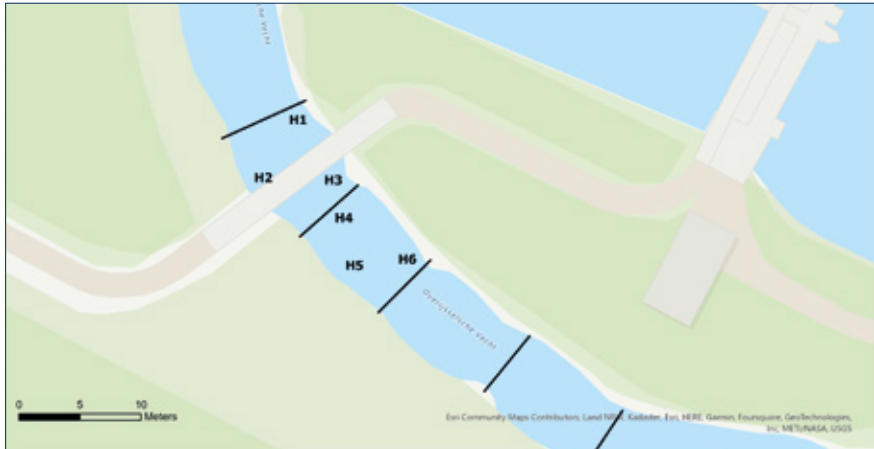
Figuur 4.4 Plaatsing hydrofoons in de vistrap bij stuw Vechterweerd (vanaf okt. 2020).
